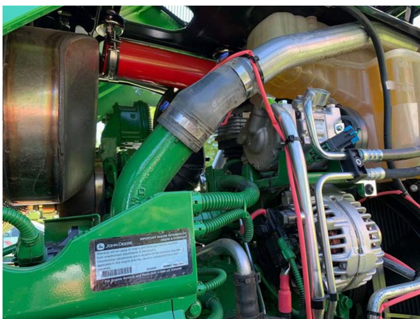
Aerosol-Löschanlagen – hier rot im Bild – können auch nachgerüstet werden.
