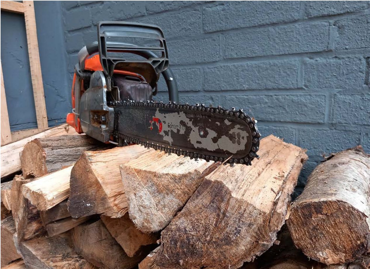
Auch bei guter Wartung ist die Haltbarkeit einer Schiene begrenzt. Neben Verschleiß können Beschädigungen eine Erneuerung erforderlich machen.
