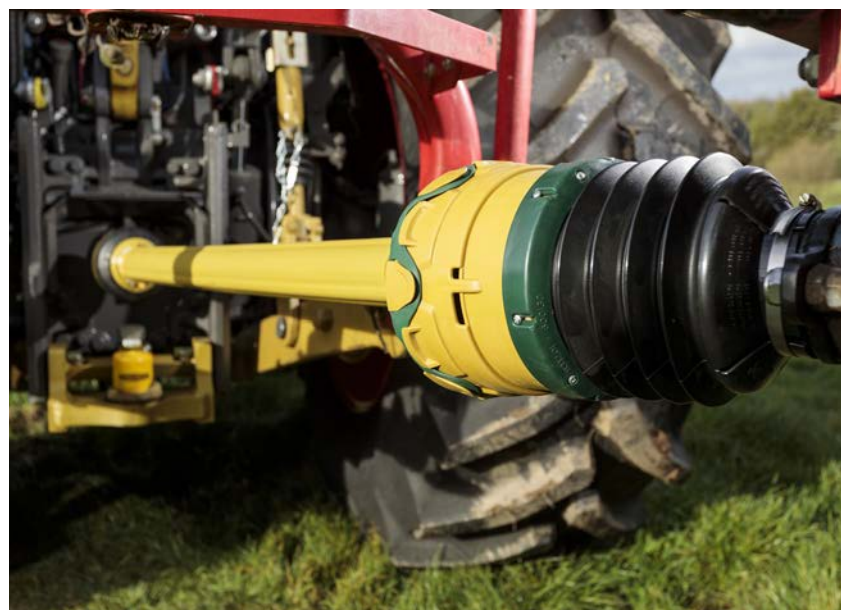
Damit das Drehmoment übertragen werden kann, darf die Gelenkwelle im Einsatz höchstens zur Hälfte auseinandergedezogen sein.
