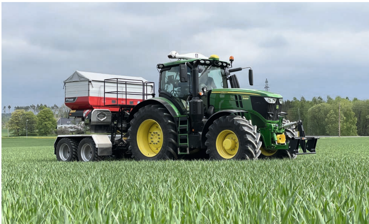
Sensoren auf dem Schlepperdach schließen durch das von den Pflanzen reflektierte Licht auf deren Chlorophyllgehalt und errechnen daraus die benötigte Düngergabe, die in der selben Überfahrt ausgebracht wird.
