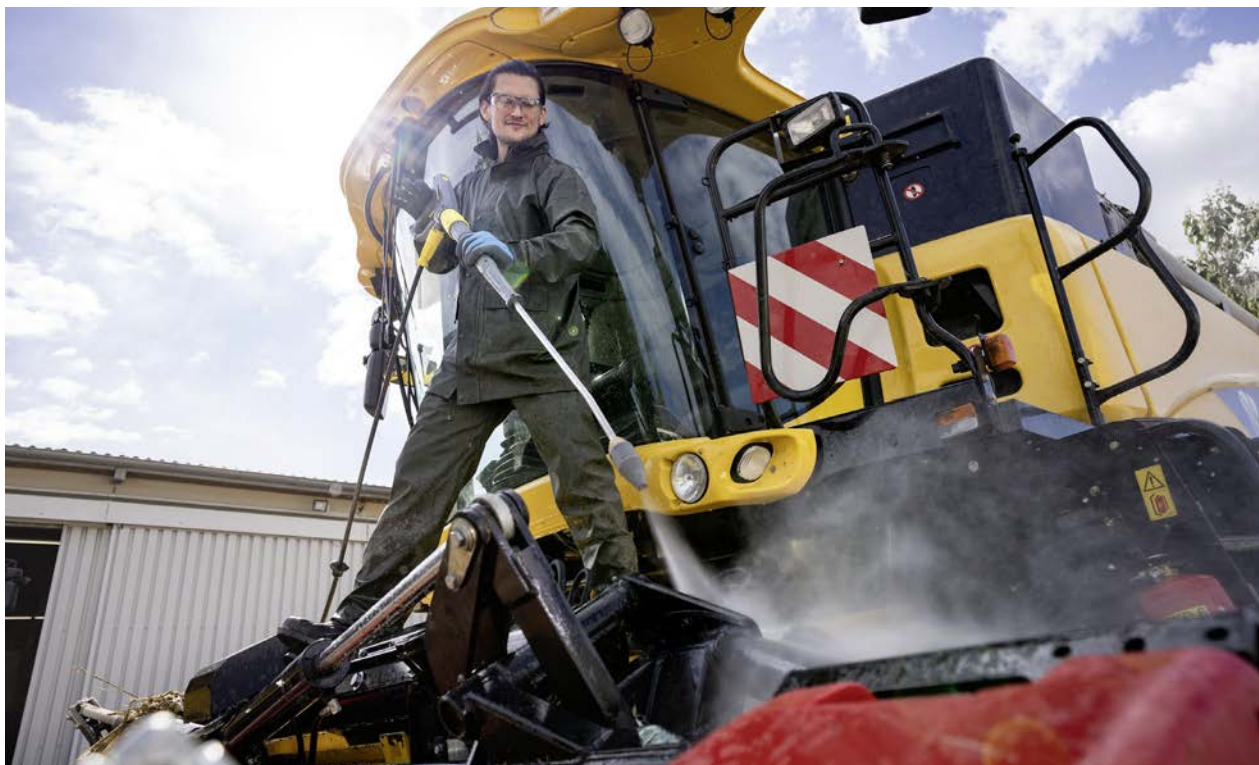
Bei der Arbeit mit dem Hochdruckreiniger ist es wichtig, Griffe fest zu umfassen, nur so ist eine wirkliche Kontrolle möglich. Der Blick soll immer dem Strahl folgen, ohne die nächste Umgebung außer Acht zu lassen.
