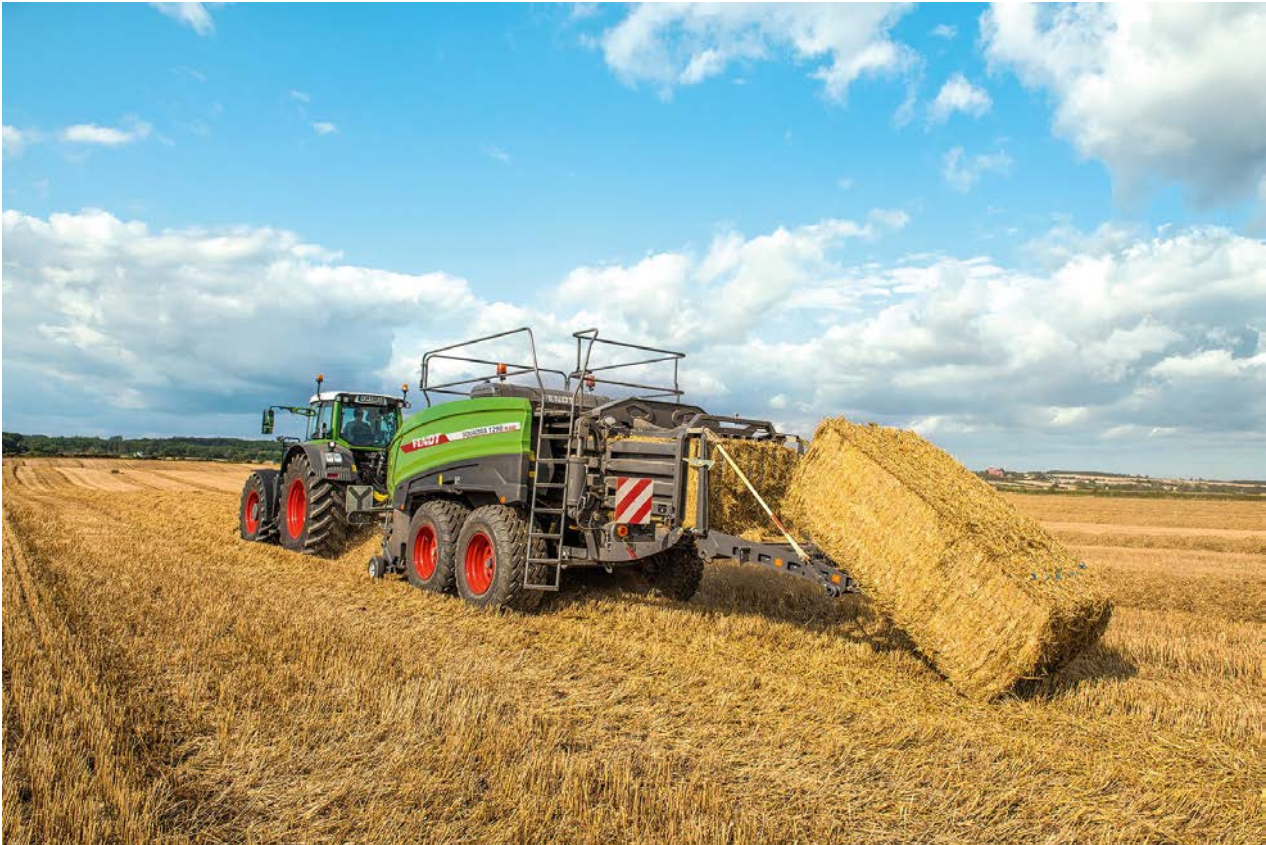
Beim Anlaufen der Großpackenpresse führt die Beschleunigung der Schwungmasse den Überlastschutz der Gelenkwelle an seine Grenzen.
