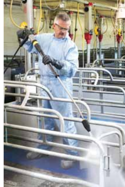
Reinigen mit Heißwasser reduziert die Keimbelastung erheblich. Außerdem wird die Raumtemperatur nicht abgesenkt.
