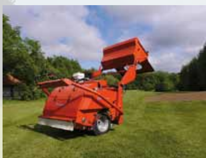
CORE RECYCLER Die Weltinnovation mit kombiniertem Sammel-/Trennsystem. Zum Aufsammeln und Verarbeiten von Erdkegeln. Spart erheblich Zeit und Kosten beim Besanden von Golf Greens. Das recycelte Material hilft durch vorhandene Nährstoffe und Bodenlebewesen zu einem schnellen Heilungsprozess nach dem Aerifiziervorgang.
