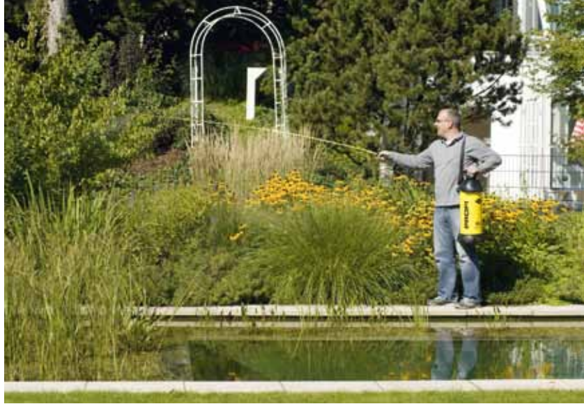
Eine Spritzrohrverlängerung erleichtert die Arbeit an schwer zugänglichen Stellen und Bäumen. Es gibt sie als Schraub- und Teleskopausführung.
