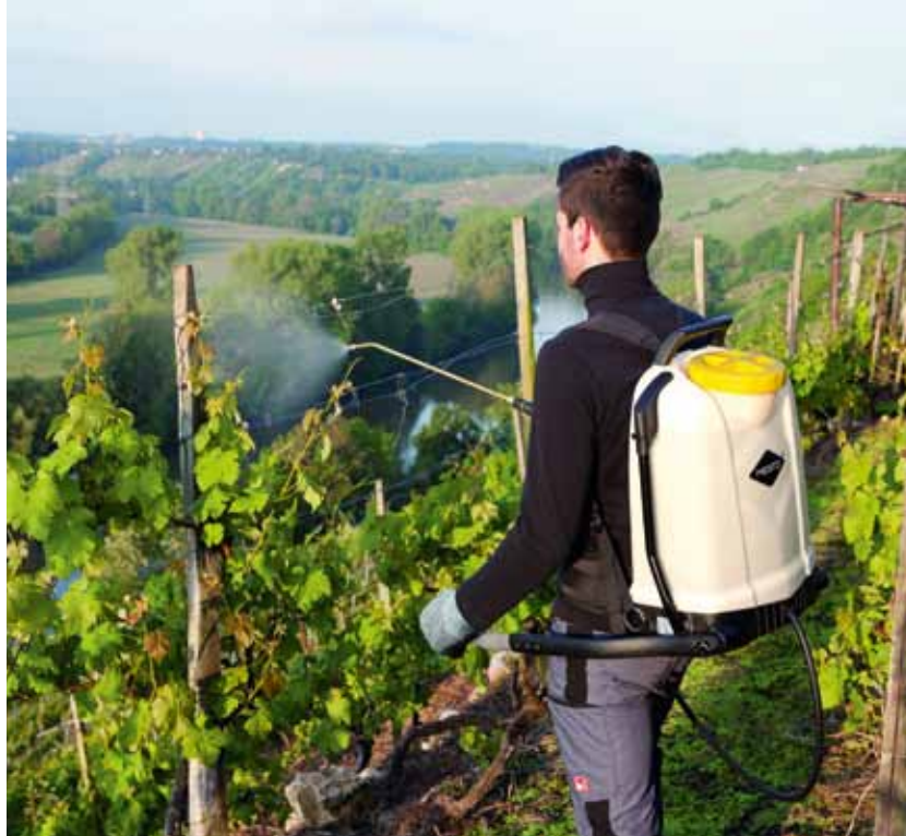
Bei Rückenspritzten wird der Betriebsdruck in einem Druckkessel durch ständiges Pumpen erzeugt. Der Vorratsbehälter bleibt drucklos.
