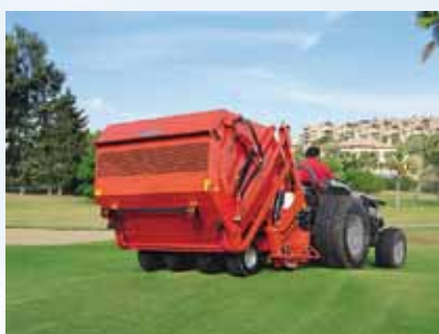
SUPER 500/SUPER 600 Die universelle, kompakte Rasenpflegemaschine zum Kehren, Vertikutieren, Mähen und zur Aufnahme von Laub sowie Schnitt- und Vertikutiergut. Als Multitalent bestens geeignet für alle größeren Sportrasenflächen.
