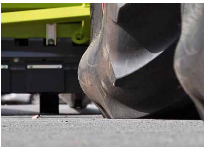
Eine große Einfederung des Reifens sorgt für erhöhte Traktion auf dem Feld.
