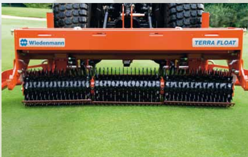
TERRA FLOAT Das intelligente Rasenpflegesystem zum Igel-, Aerifizieren und Nachsäen von Golf Greens und Tees. Mit dreigeteilter, pendelnder Werkzeugwalze zur optimalen Anpassung der Igel- oder Sternsegmente an modelliertes Gelände. Das Gerät ist ebenfalls zur Bekämpfung von Algenbelägen geeignet, da diese durch die Perforation schneller austrocknen können.
