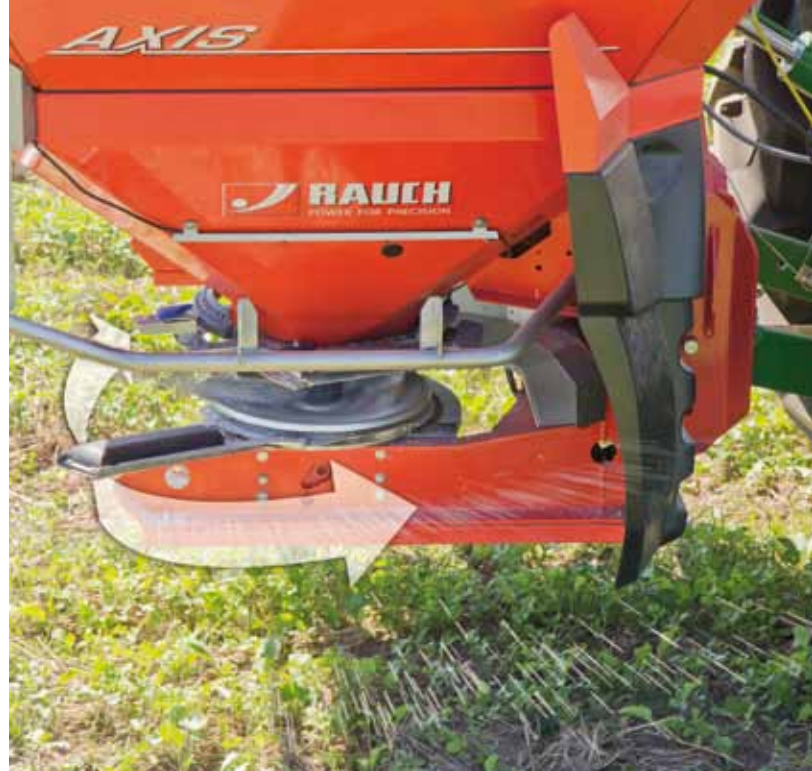
Um die Querverteilung zu verbessern, wurden Sensoren zur Streufächererfassung entwickelt.
