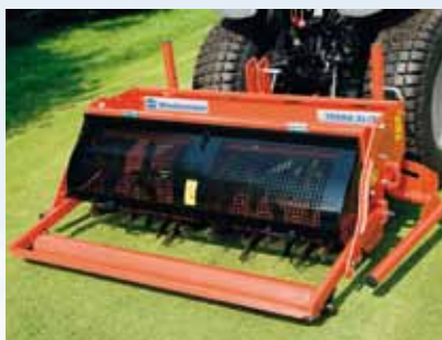
TERRA SLIT Beseitigt effektiv Bodenverdichtungen bis 20 cm Tiefe. Je nach Verdichtungsgrad und Bodenverhältnissen mit Standard- oder Intensivlockermesser ausrüstbar. Zum Schlitzeln bis 15 cm Tiefe auch mit Feinschnittmesser und zum Ausstechen von Rasenfilz bis 8 cm Tiefe mit Hohlspoons ausrüstbar.
