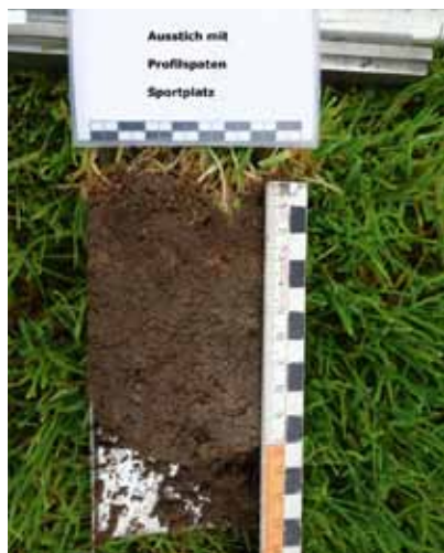
Für die Spatenprobe wird ein Dreieck aus dem Boden ausgestochen und durch Sicht- und Fingerprobe die Feuchtigkeit ermittelt. Das Foto zeigt einen speziellen Profilspaten.
