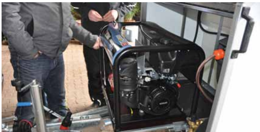
Der Generator ist beim ELMOTherm Vario wartungsfreundlich auf Schlittenausügen montiert.
