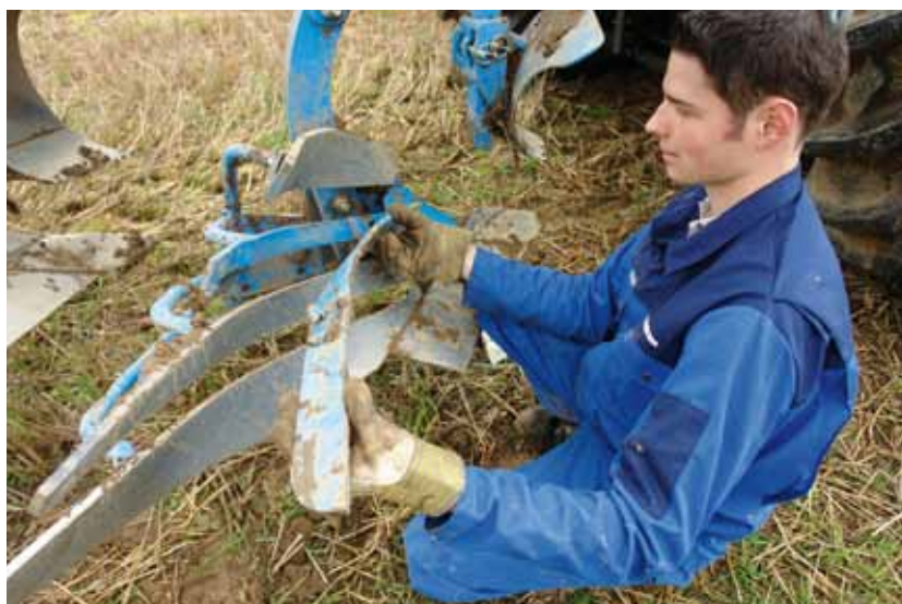
DuraMaxx Pflugkörper werden nur eingehakt und lassen sich dadurch schnell und einfach wechseln
