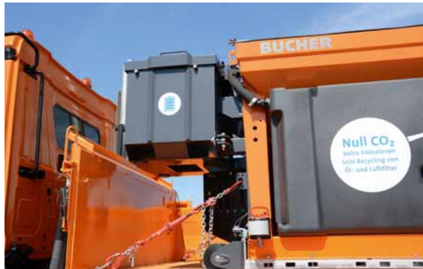
Bewährte Batterietechnik kommt zum Einsatz. Ladezeiten werden durch ein zweites Batteriepack vermieden.
