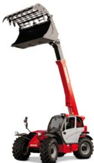
Vereint Möglichkeiten des Radladers mit denen eines Gabelstaplers: der Teleskoplader
