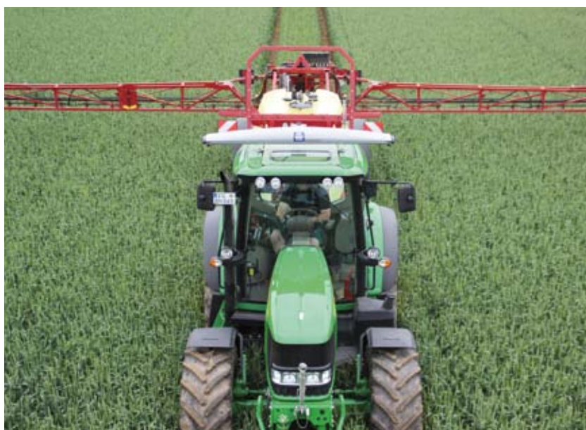
Neben den Daten für eine bedarfsgerechte Düngung liefert der Yara N-Sensor auch Daten für eine korrekte Dosierung in den Teilbreiten beim Pflanzenschutz.
