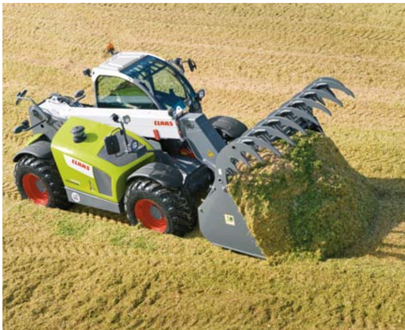
Durch unterschiedlichste Anbaugeräte gewinnt der Teleskoplader eine große Vielseitigkeit. Schnellwechselsysteme halten Umrüstzeiten kurz.
