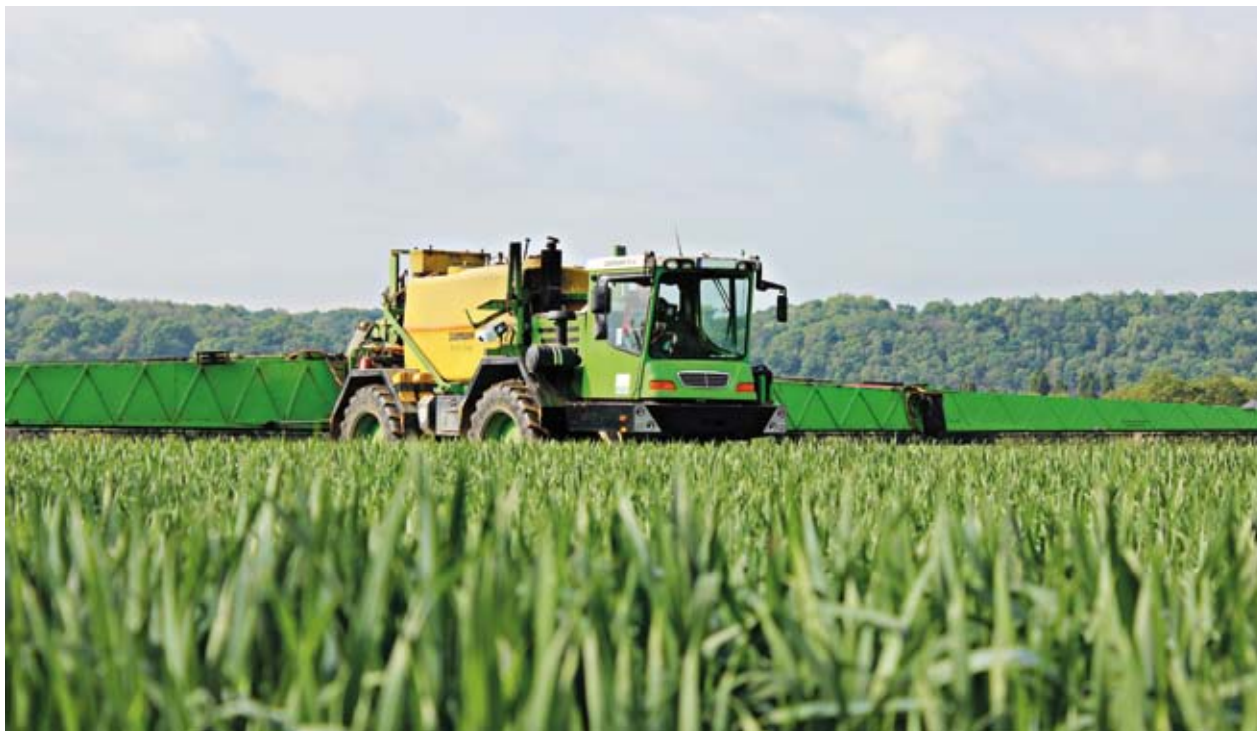
Anders als beim Yara N-Sensor ist die Bauform des P3-Sensor ALS aufgelöst (ein Bauteil hier über dem Vorderrad) und die komplette Technik in zwei separaten Sensorköpfen untergebracht.
