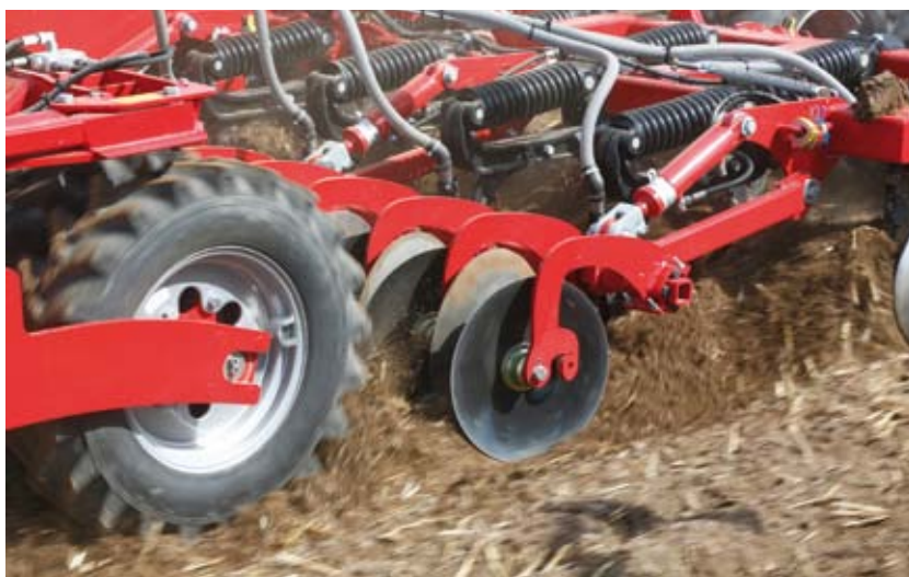
Die TerraGrip-Zinken lockern den Boden streifenförmig, fördern Ernterückstände aus der Saatreihe und keine groben Kluten nach oben. Sie legen außerdem das Düngerdepot ab.
