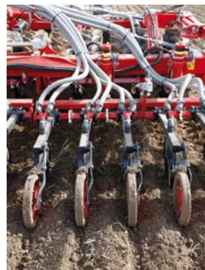
Die Aussaat mit den TurboDisc-Scharen erfolgt in den streifenförmig bearbeiteten Boden.
