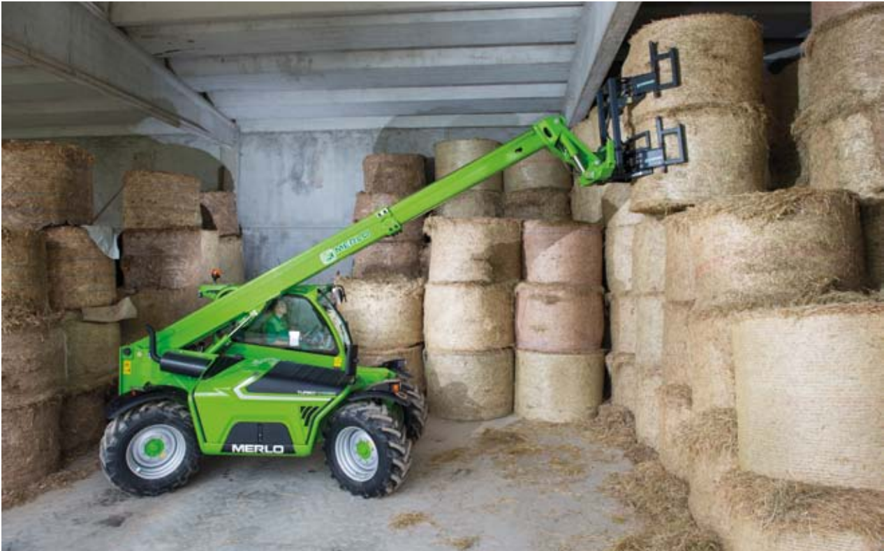
Durch eine Allradlenkung erhält ein Teleskoplader eine enorme Wendigkeit.
