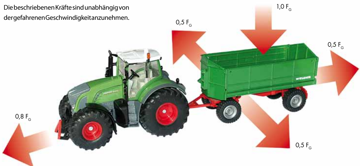
Massenkräfte im Fahrbetrieb F_G = Gewichtskraft der Ladung
