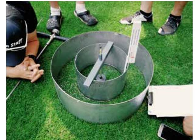
Messen der Wasserdurchlässigkeit des Bodens: Doppelringinfiltrrometer
