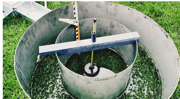
Messen der Wasserdurchlässigkeit des Bodens mit dem Doppelringinfiltrimeter
