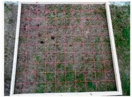
Abb. 4: Schätzrahmen zur Ermittlung der Narbendichte (Deckungsgrad in %).
