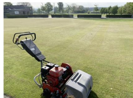
Abb. 10: Verwendeter Jacobsen Handmäher.
