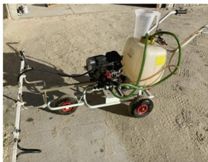
Abb. 8: Fox Sprayer für Flüssigdünger-variante
