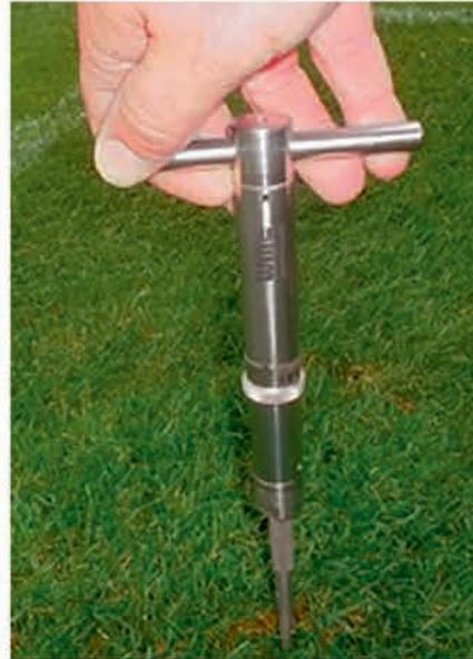
Abb. 3: Scherfestigkeitsmessung mit einer Flügelsonde.
