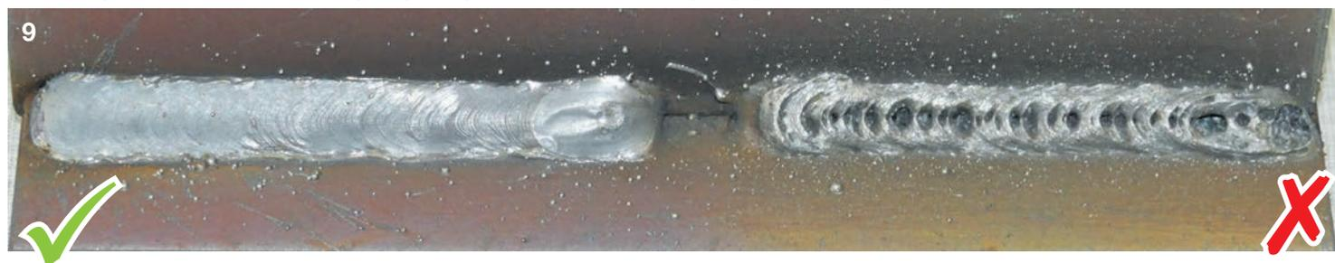
10 Nicht optimale Schweißnaht: Der Brenner wurde zu schnell bewegt (l.) beziehungsweise der Drahtvorschub war zu groß (r.).
