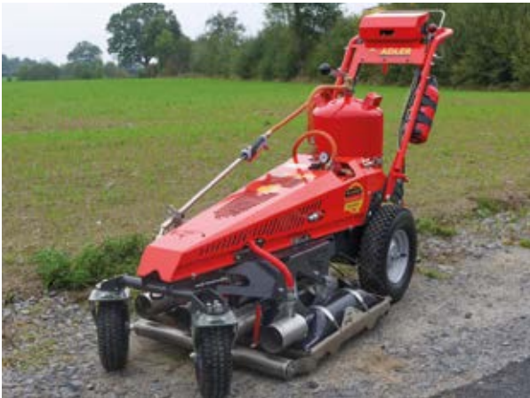
Gasbetriebene Infrarotstrahler sind leise und können auch auf wassergebundenen Flächen eingesetzt werden. Dieses Modell der Firma Adler verfügt über einen Elektroantrieb sowie einen Handbrenner für unzugängliche Bereiche.
