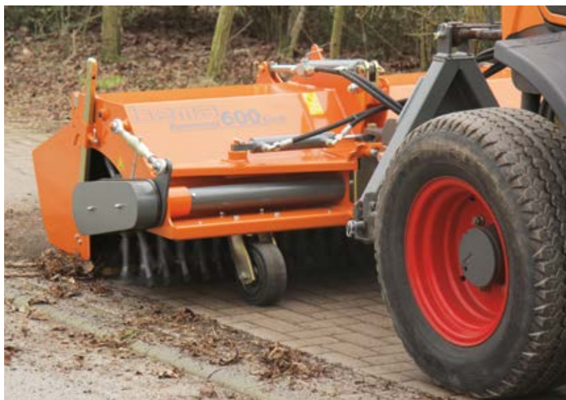
Durch große Flächenleistung zeichnet sich dieses bema-Gerät aus. Der Hersteller gibt an, dass vorhandene Kehrmaschinen nachgerüstet werden können.
