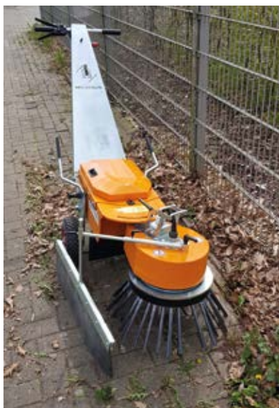
Handgeführte Bürstensysteme gibt es mit Verbrennungsmotor wie auch Akkubetrieb. Der Hersteller Michaelis bietet beide Varianten und kann auf langjährige Erfahrung verweisen.
