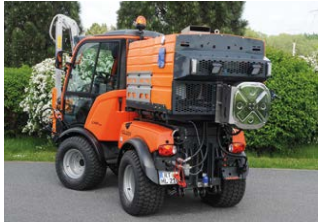
Vorhandene Tanksysteme wie dieses der Firma Fiedler lassen sich um Heißwassergeräte zur Unkrautbekämpfung ergänzen.
