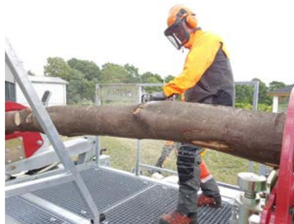
*Einsatz des Spannungssimulators in der Motorsägenausbildung*
