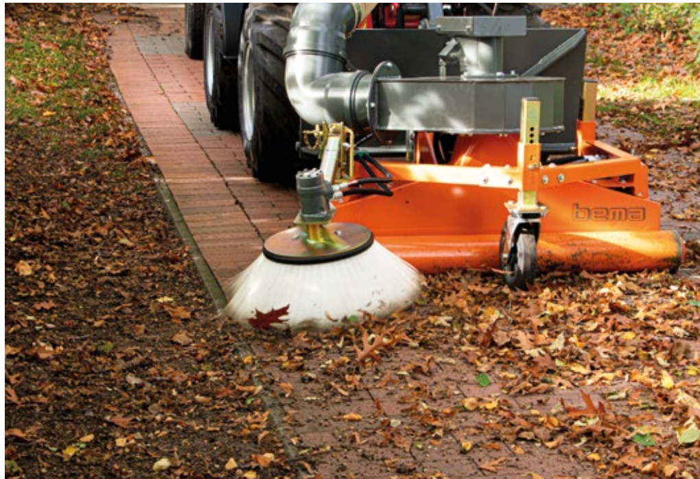
Die bema Saug-Kehrdüse bei der Arbeit. Sie beseitigt schnell und gründlich Laub und sonstiges Kehrut.
