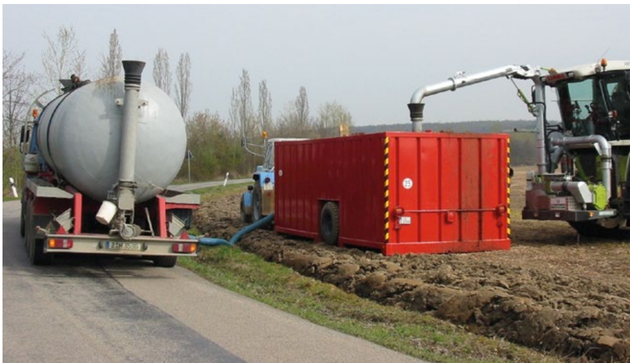
Mit zunehmender Technikgröße wird jede Warteminute kostenrelevant. Es kommt der Feldrandcontainer als Pufferspeicher ins Spiel.
