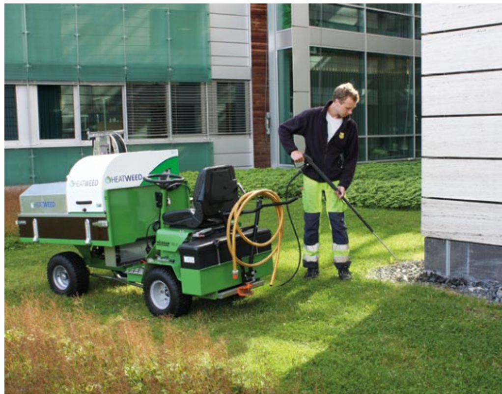
Heatweed Technologies GmbH gewährleistet nach eigenen Angaben mit ihrer Aktiven Temperaturregelung (ATR) eine präzise Wassertemperatur von 98 bis 99,6 °C.
