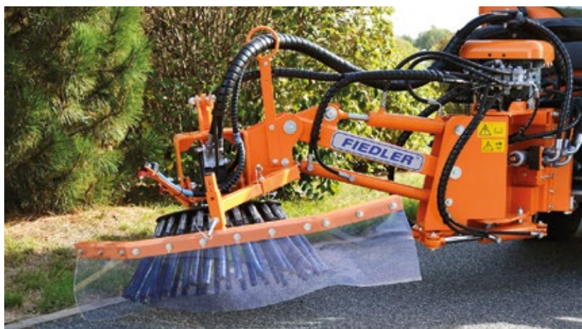
Bei Wildkrautbürsten entscheiden über den Erfolg im Wesentlichen Beschaffenheit und Material der Bürsten. Es sind Systeme mit Stahl- oder Kunststoffborsten sowie Materialmixe am Markt.
