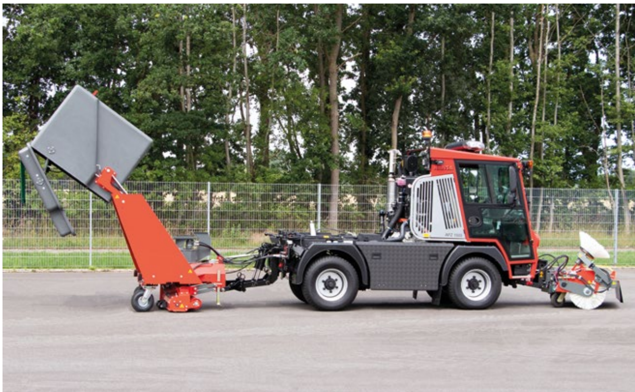
Neu ab Herbst 2020: Komplette Heckeinheit aus bema Saug-Kehrdüse, Häckselgebläse und bema Kippcontainer. An der Front ist hier als Ergänzung eine bema Kehrmaschine zu sehen
