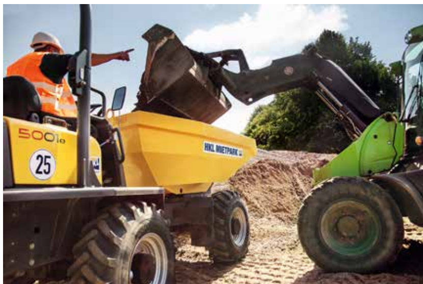
Im Gegensatz zum Radlader hat der Dumper mehr Ladevolumen und die günstigere Lastenverteilung auf alle vier Räder
